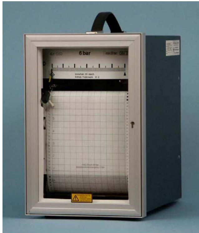
R = Rohrfedermesswerk oder Edelstahlrohfedermesswerk
